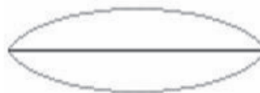
Primeiro modo de vibração de uma onda estacionária em uma corda esticada. L = \lambda/2
