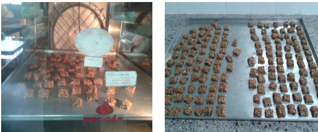
Figura 6. Barras prontas para embalagem após tratamento térmico 100°C em forno elétrico. Fonte: Acervo Próprio
