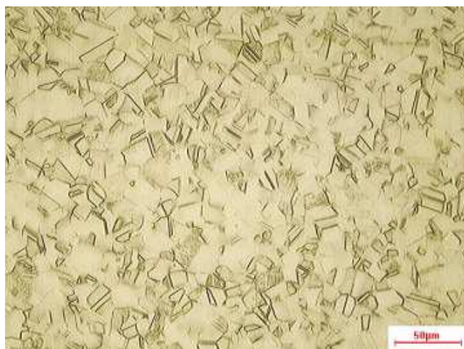
Figura 3 – Micrografia do aço austenítico 304.
