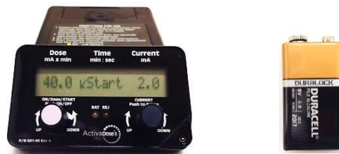
FIGURA 2: Imagem frontal. Aparelho gerador de corrente contínua alimentado por uma bateria de nove volts.
