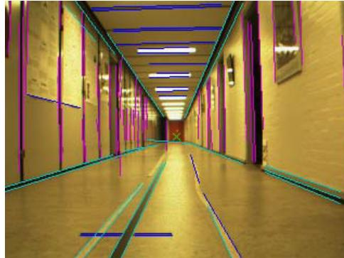
Figura 9 – Robô navegando em um corredor de um ambiente indoor usando OV para estimar a *pose* (BAYRAMOGLU et al., 2009).
