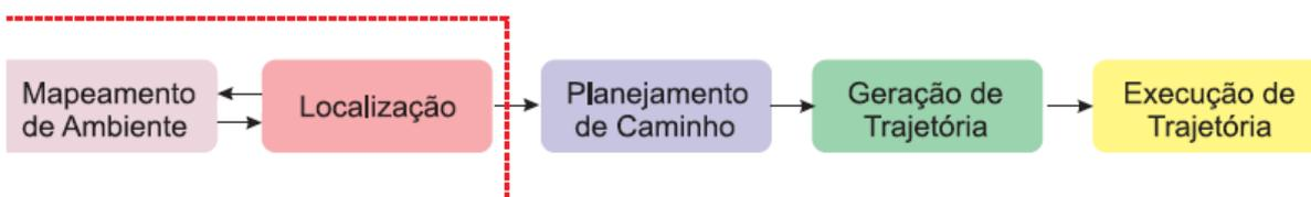
Figura 3 – Fluxo de dados navegação robótica (Adaptação de [Alsina et al. \(2002\)](#)).
