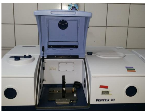
Figura 16 Espectrômetro no infravermelho utilizado na obtenção dos espectros.
