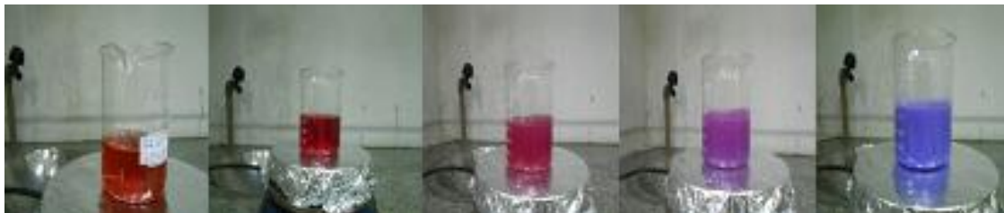
Figura 11 mudança de cor na solução em agitação em função do tempo
