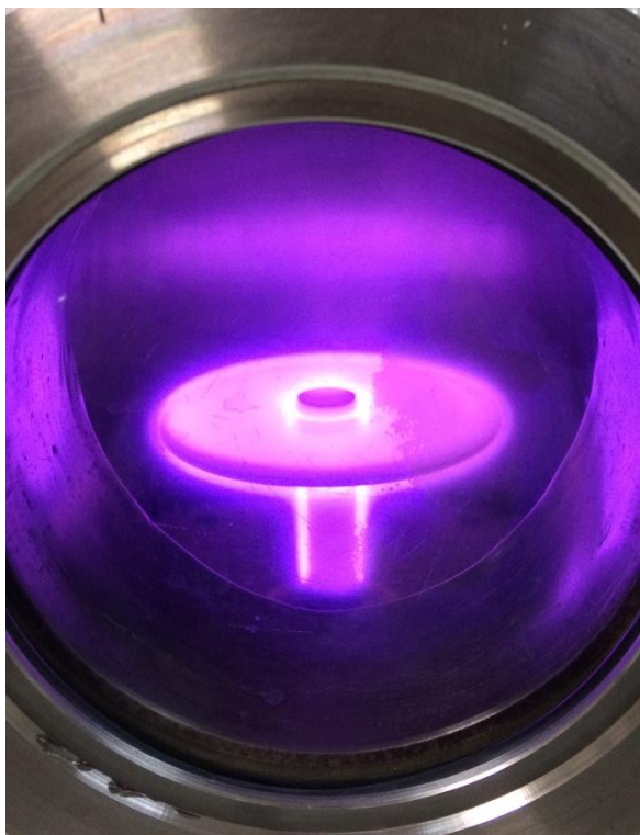
Figura 10 - Plasma gerado em processo de nitretação a plasma no LABPLASMA – IFPI revestindo amostra dentro do reator.
