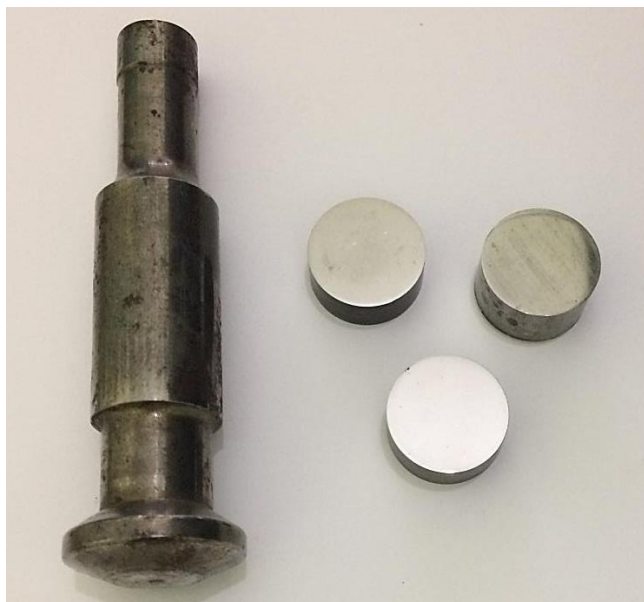
Figura 9 - Amostras obtidas a partir do corte do corpo do punção apresentado, cedido pela UFPI.
