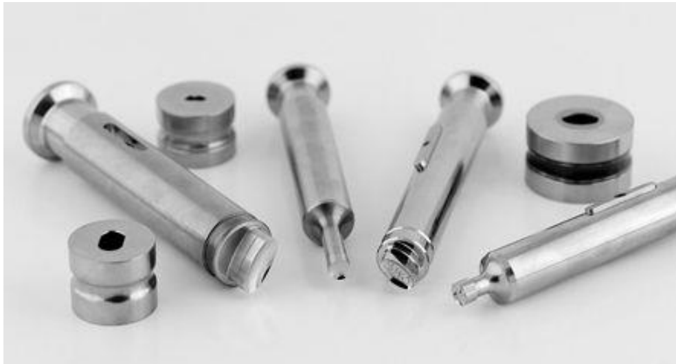
Figura 3 - Punções e matrizes utilizadas no processo de produção de comprimidos.
