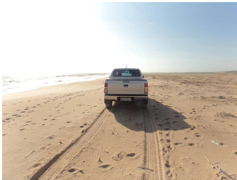
Figura 19 – Demarcação da linha de praia através do monitoramento por GPS com a utilização de um veículo
