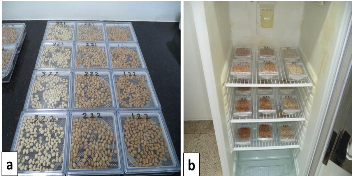
Figura 2: Teste de envelhecimento acelerado: a – Sementes de feijão-caupi em caixas gerbox; b – Caixas gerbox com sementes de feijão-caupi em câmara tipo BOD; Fonte: SANTOS, S. E. M.
