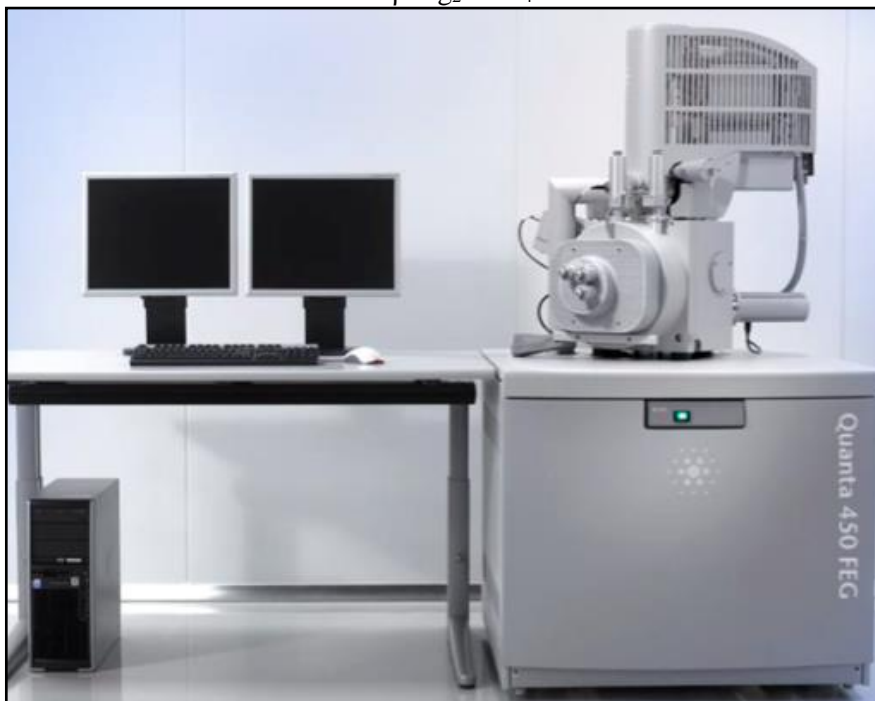
Figura 2.14 – Microscópio eletrônico de varredura Quanta-450 FEG utilizado na análise morfológica do \beta\text{-Ag}_2\text{MoO}_4 .
