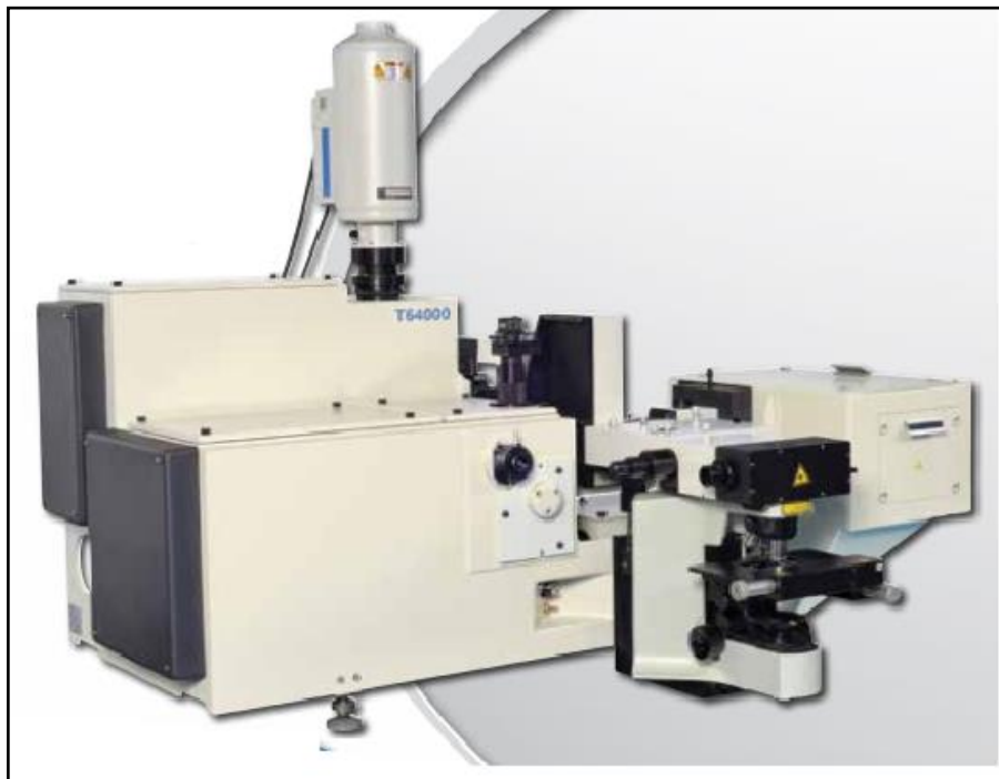
Figura 3.3 - Espectrômetro utilizado nos experimentos de espectroscopia Raman.
