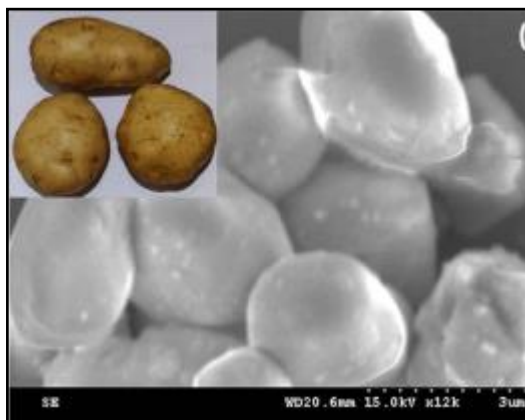
Figura 2.3 – Imagem obtida por MEV do \beta\text{-Ag}_2\text{MoO}_4 com microestrutura potato-like .
