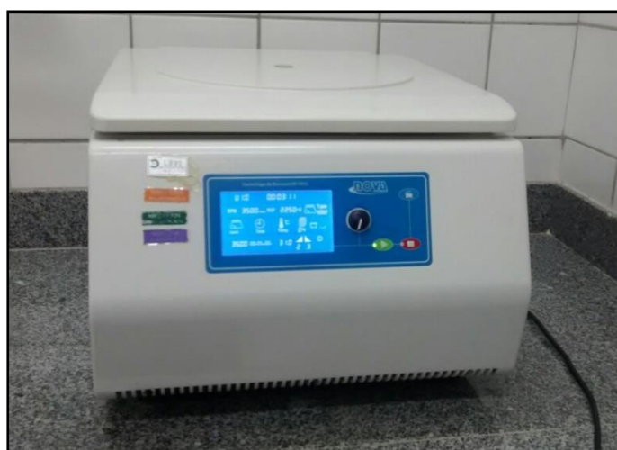
Figura 2.7 – Centrífuga utilizada para lavagem da amostra.
