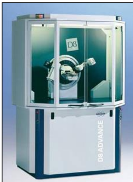
Figura 2.8 – Difratômetro de raios-X utilizado na caracterização estrutural do \beta -Ag 2 MoO 4 .
