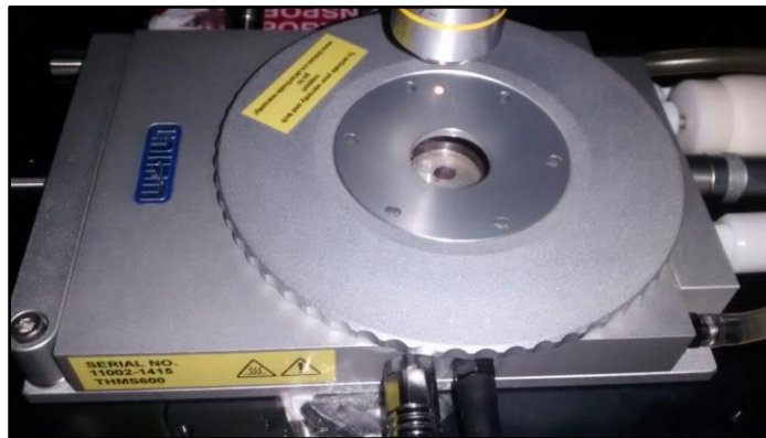
Figura 2.12 – Câmara de temperatura acoplada aos experimentos de espectroscopia Raman.
