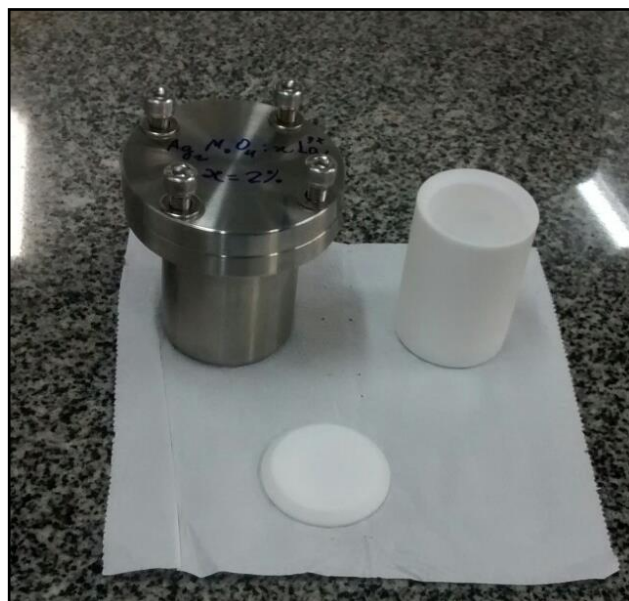
Figura 2.5 – Autoclave de inox com copo de teflon para tratamento hidrotérmico.
