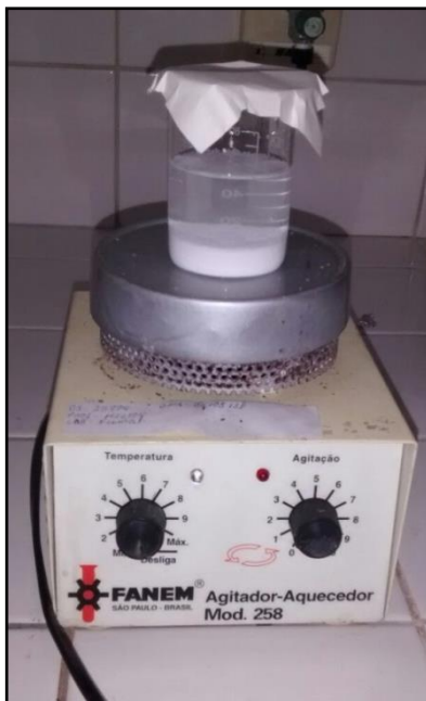
Figura 2.4 – Agitador magnético utilizado para agitação das amostras.
