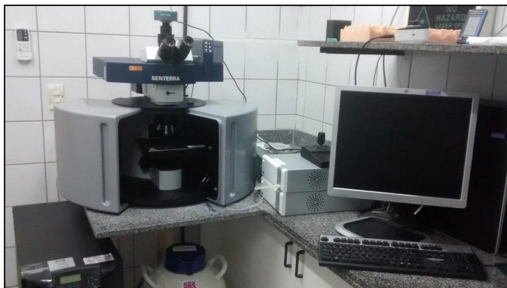
Figura 2.11 – Espectrômetro SENTERRA utilizado nos experimentos de espectroscopia Raman.
