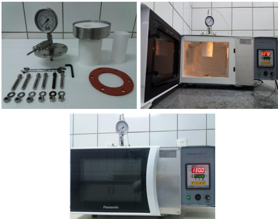
Figura 7 - Fotografia do reator hidrotérmico assistido por microondas e seus componentes utilizados na síntese dos materiais em estudo.
