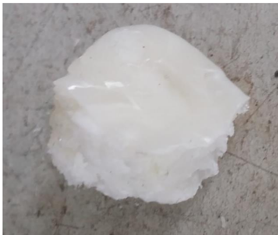
Figura 18 – Imagem de cola demonstrando o interior fosco composto de amido e a superfície brilhante de resina
