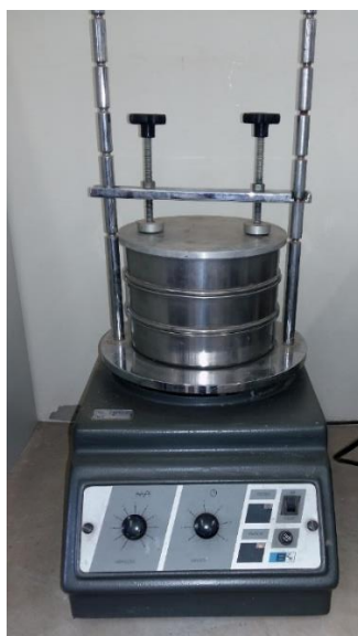
Figura 4 – peneiras e agitador para tamização
