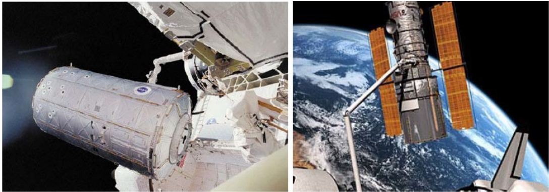
Figura 4.6 Canadarm colocando um satélite em órbita (à esquerda) ou reparando o telescópio Hubble (à direita).
