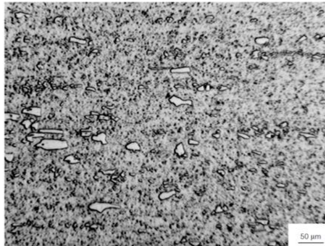
Figura 1 - Microestrutura típica de aço D2 para trabalho a frio.
