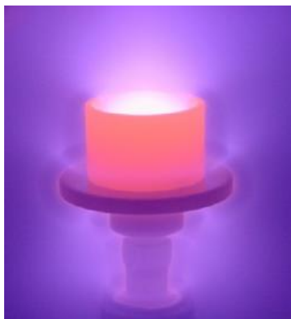
Figura 8 - Efeito de cátodo oco em um cilindro.
