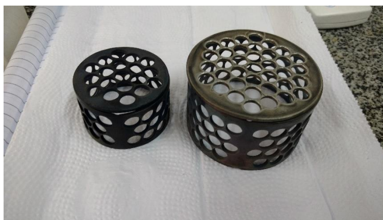
Figura 17- Gaiolas catódicas utilizadas nos tratamentos.
