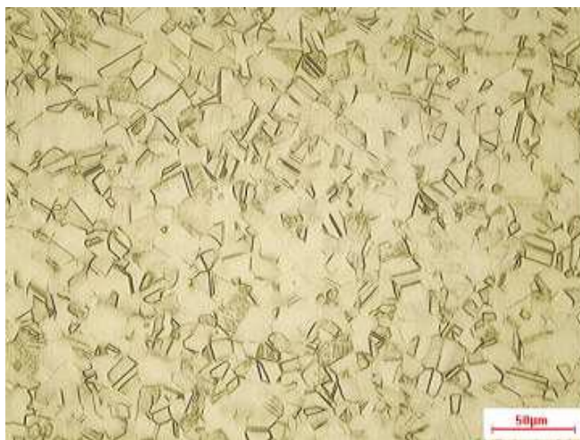
Figura 2- Micrografia do aço austenítico 304.
