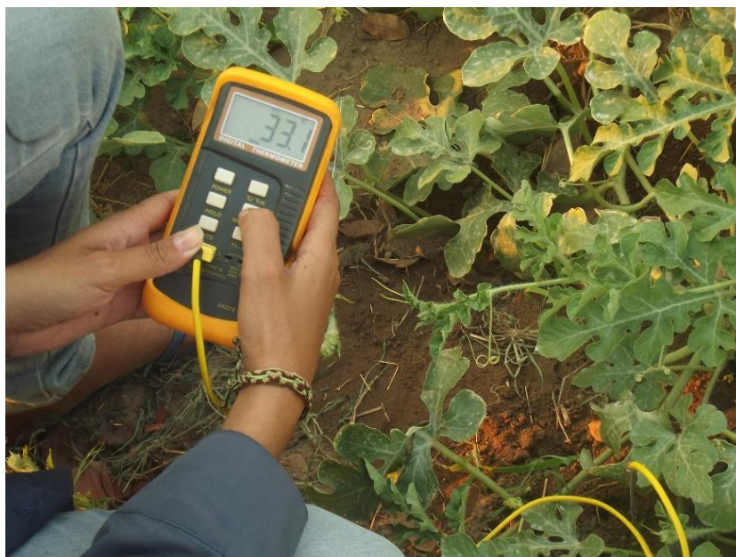
Figura 6. Sensor Termopar tipo K conectado a termômetro digital (17h:28min)
