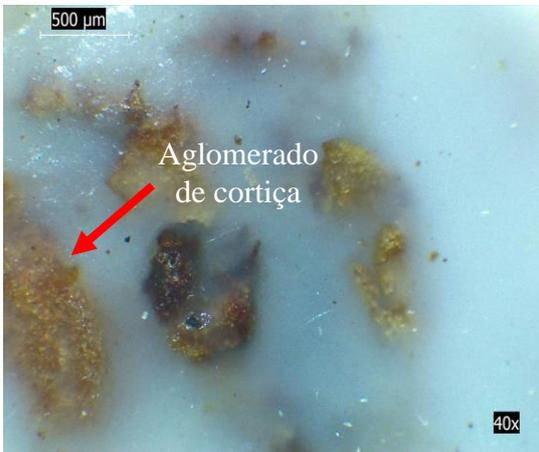
Superfície sem fratura: PVC/5CG
