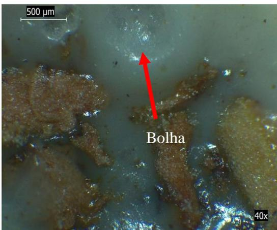
Superfície sem fratura: PVC/10CG
