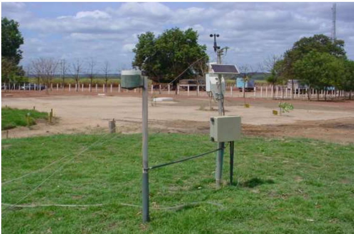
Figura 9 - Estação agrometeorológica automática instalada na Usina COMVAP.
