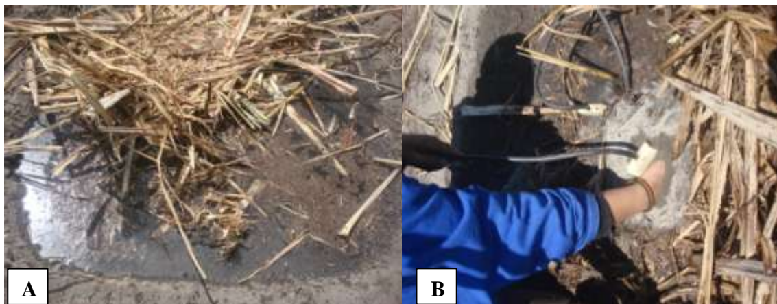
Figura 6 - Saturação do solo (A) e instalação das sondas da TDR 100 nas duas profundidades do solo (B), para obtenção dos dados para calibração do aparelho as condições locais do solo. Usina COMVAP, União - PI, 2013.
