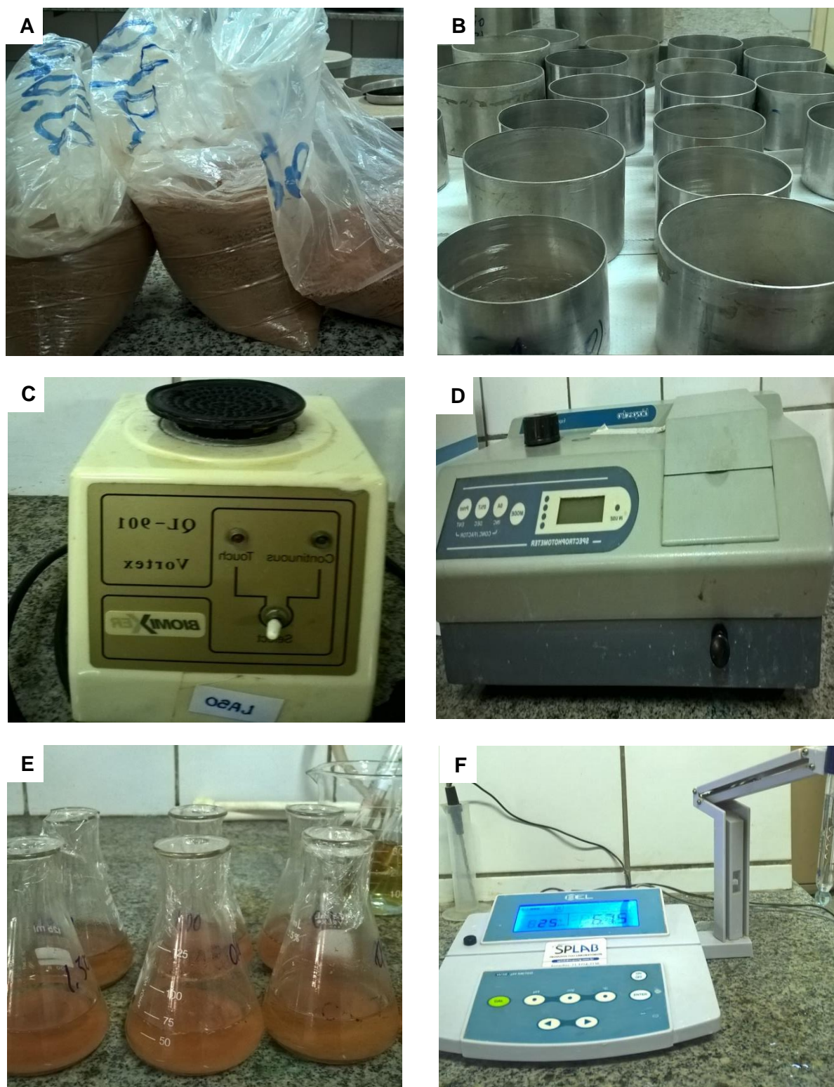
Figura 1. Amostras em saco plástico (A), recipiente para secagem das amostras (B), agitador de tubos de ensaio (C), espectrofotômetro (D), amostras em balão volumétrico (E) e pHmetro (F).
