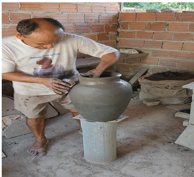
Fotografia 13 - Finalização do pote com a modelagem da boca
