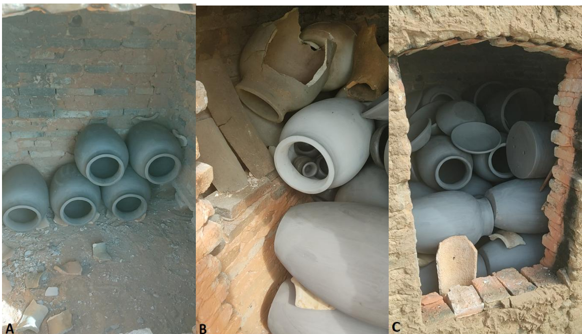
Fotografia 25 - Organização das peças dentro do forno
