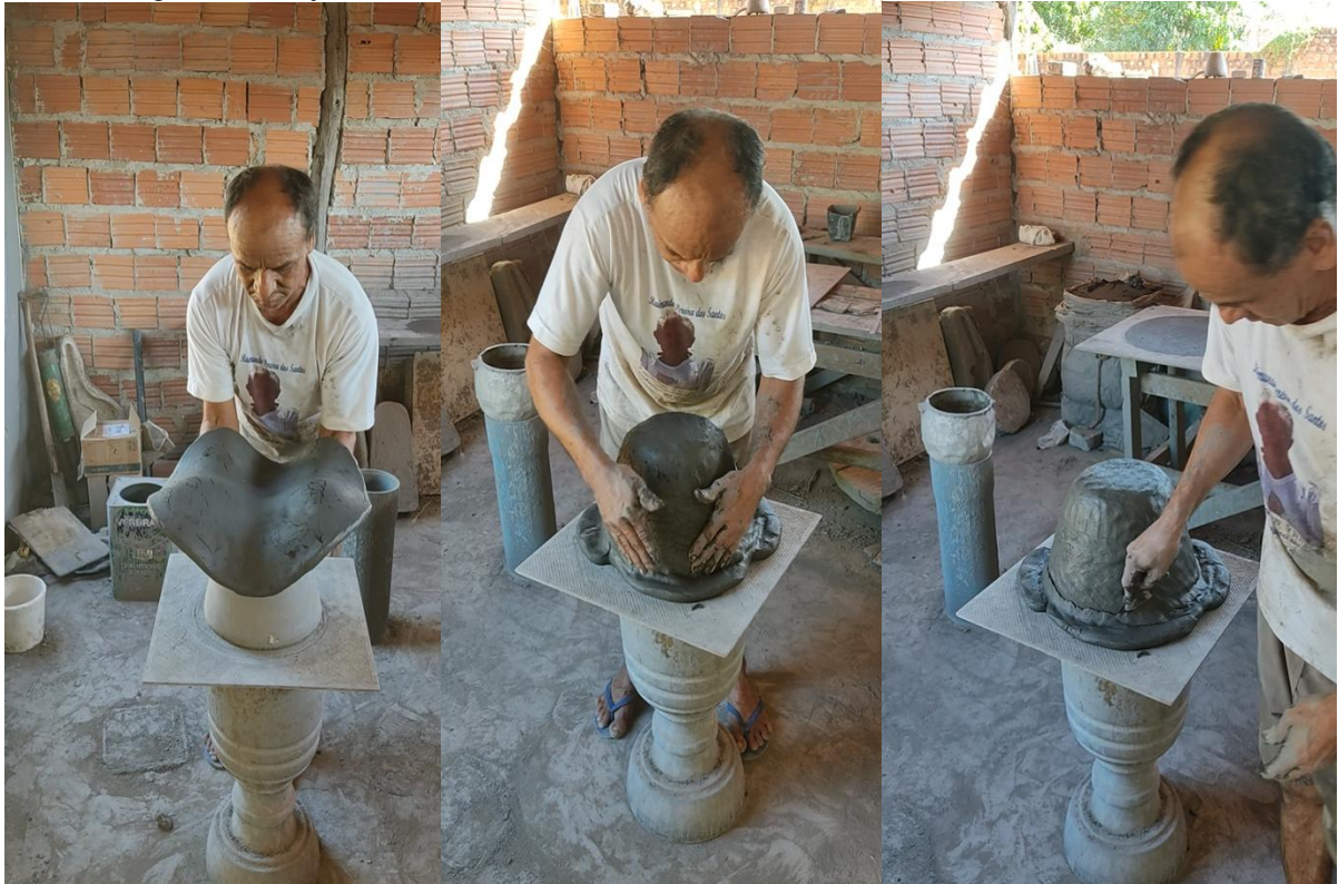
Fotografia 15 - Ajustando a massa à fôrma
