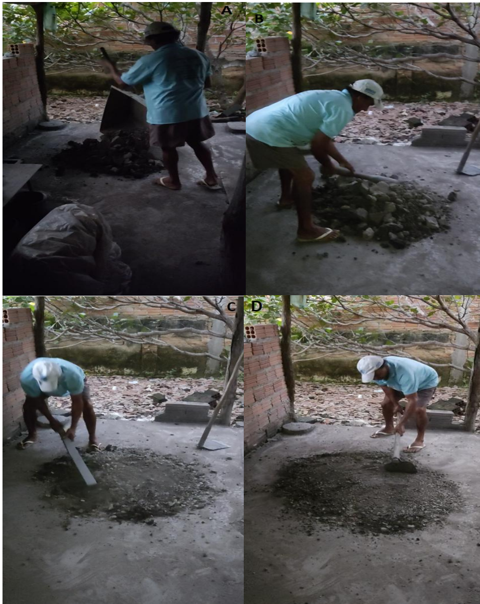
Fotografia 10 - Procedimento de quebra das pedras de argila
