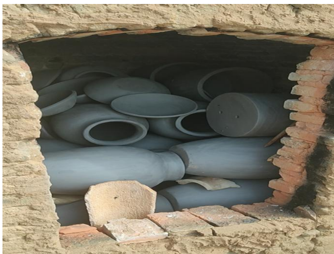
Fotografia 17 - Organização das peças dentro do forno
