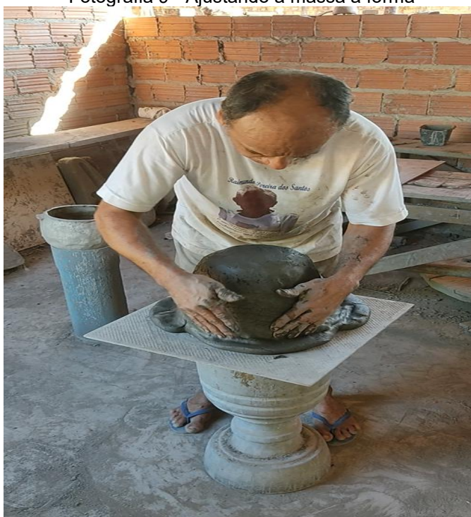
Fotografia 9 - Ajustando a massa à fôrma
