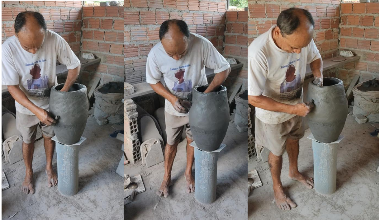
Fotografia 19 - "Puxada" do barro com sabugo e cuia
