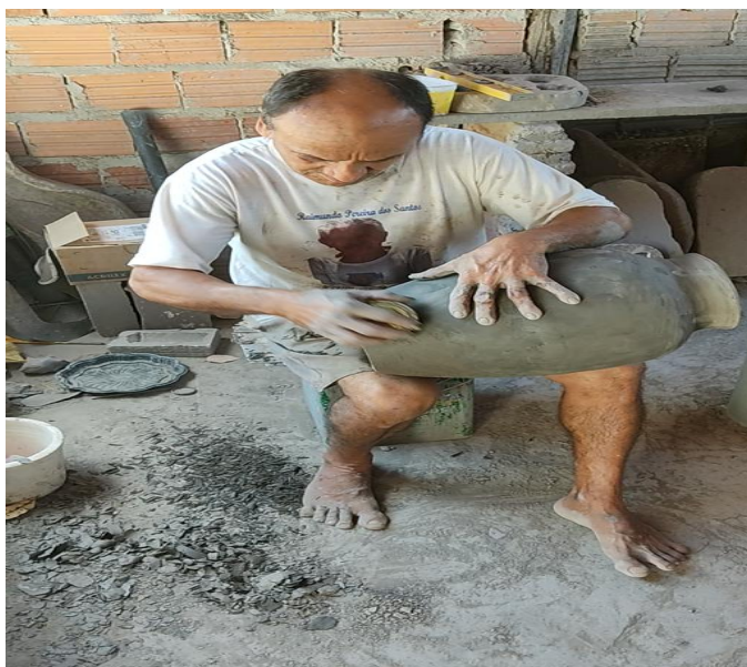
Fotografia 14 - Raspagem da peça
