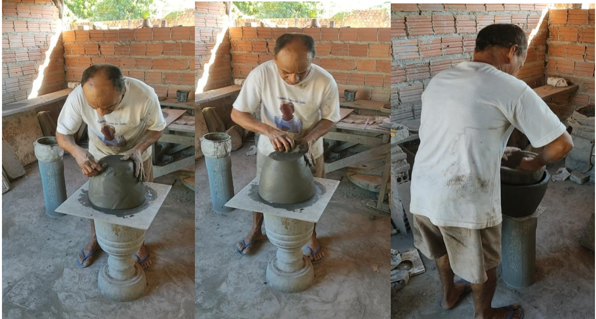
Fotografia 16 - Unindo a massa ao molde e sua retirada
