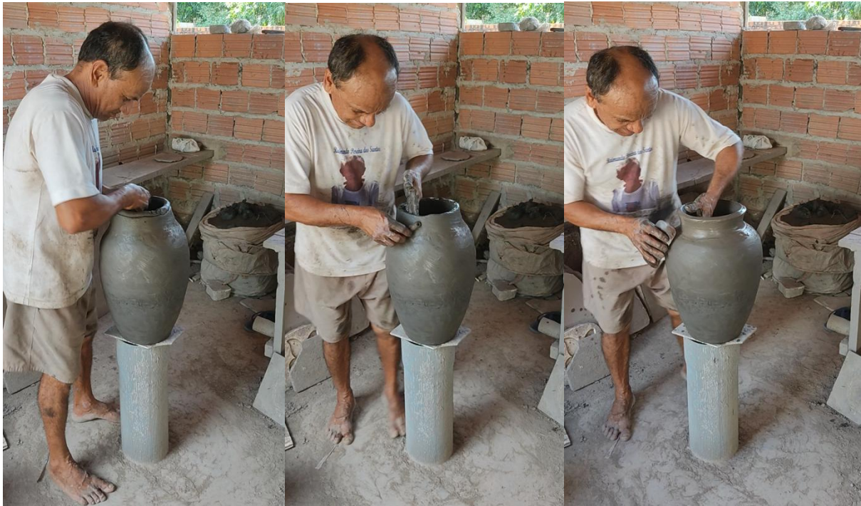
Fotografia 20 - Fixação do último rolete e a finalização do pote com a modelagem da boca
