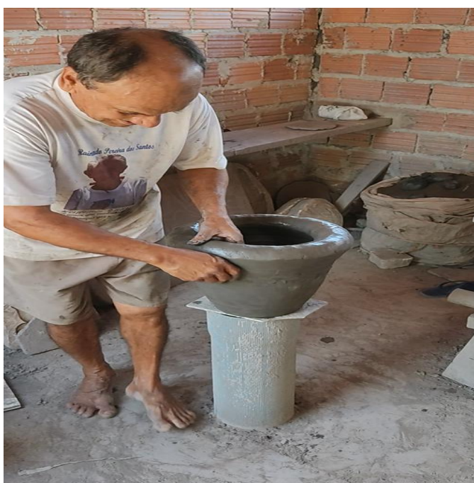
Fotografia 11 - Fixação do primeiro rolete
