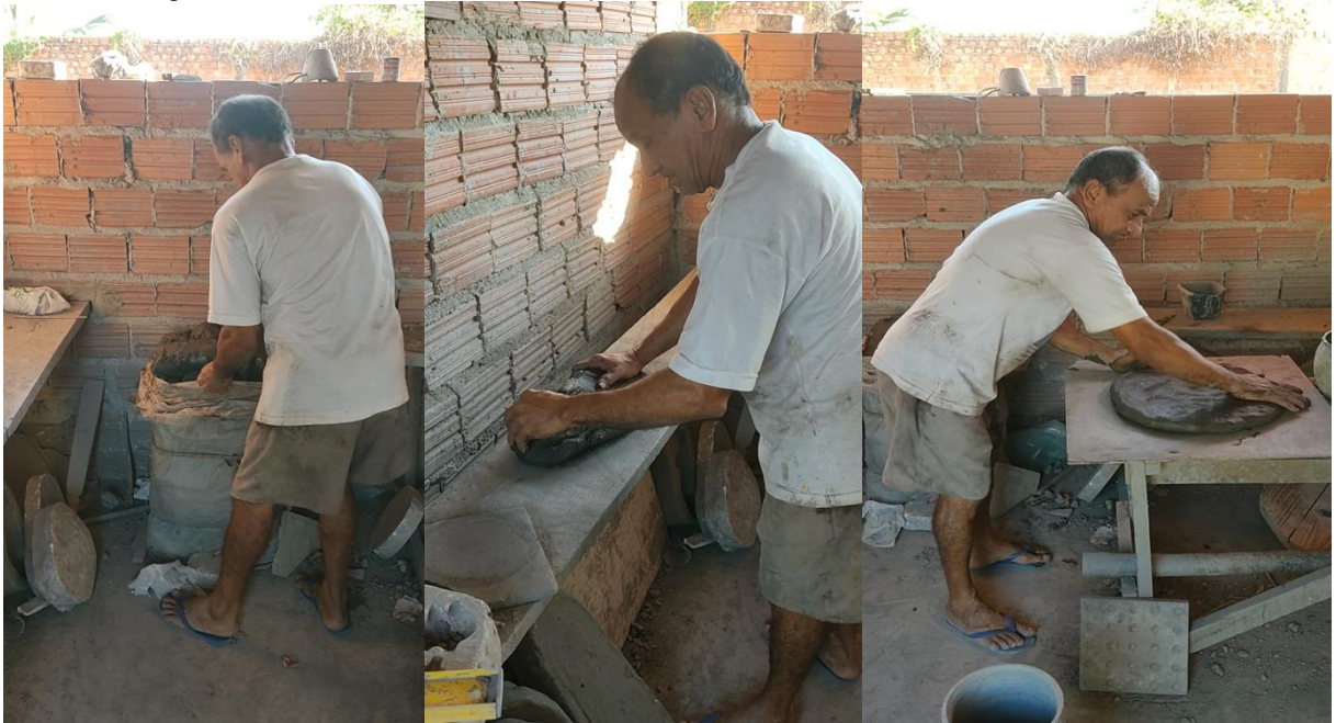
Fotografia 14 - Amassando a massa para início da modelagem
