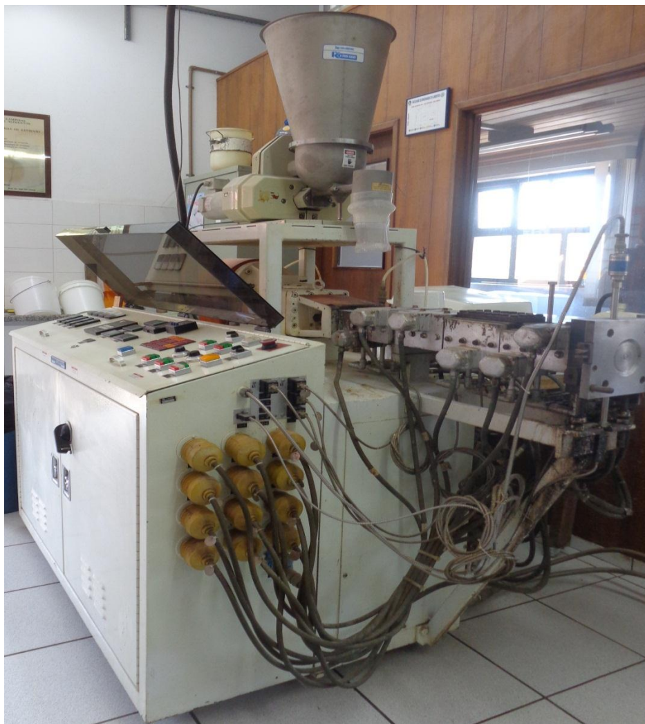
Figura 1: Extrusor termoplástico dupla-rosca utilizado na elaboração dos snacks extrusados.
