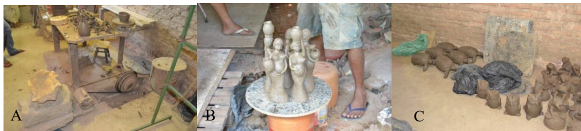
Figura 10. Processo de moldagem das peças cerâmicas pelos artesãos do Polo Cerâmico do Poti Velho, Teresina, Piauí: (A) em torno elétrico, (B) peças moldadas (C) essecagem das peças (C)
