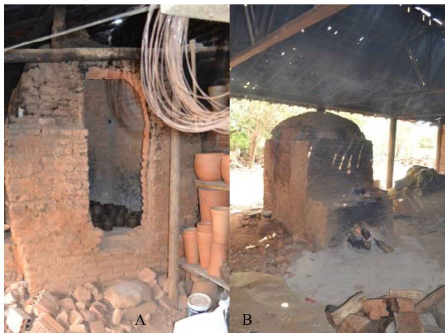
Figura 11. Momento de “enfornar” as peças (A) e da queima (B), no Polo Cerâmico do Poti Velho em Teresina, Piauí
