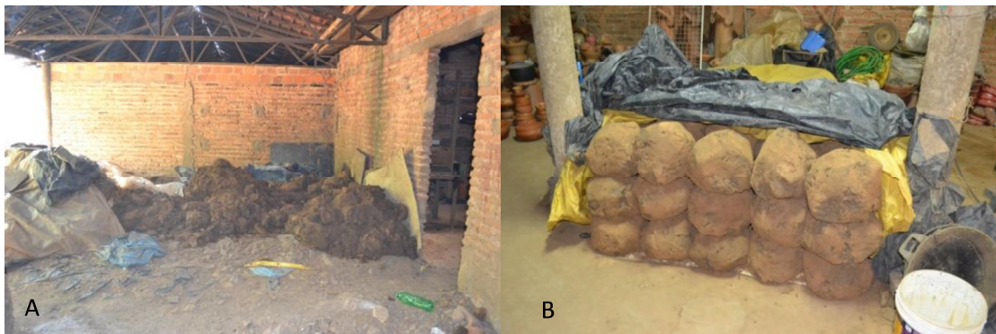
Figura 6: Argila bruta (A) e “trabalhada” (B), utilizadas pelos artesãos do Polo Cerâmico do bairro Poti Velho, Teresina, Piauí
