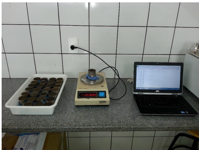
Figura 7 – Amostras de solo em bandeja durante pesagem.
