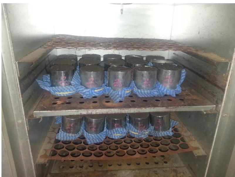
Figura 9 – Amostras de solo no interior da estufa a temperatura de 105°C.
