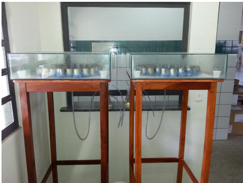
Figura 8 – Mesas de tensão com amostras coletadas com amostras quando da aplicação de 30 cmH 2 O.
