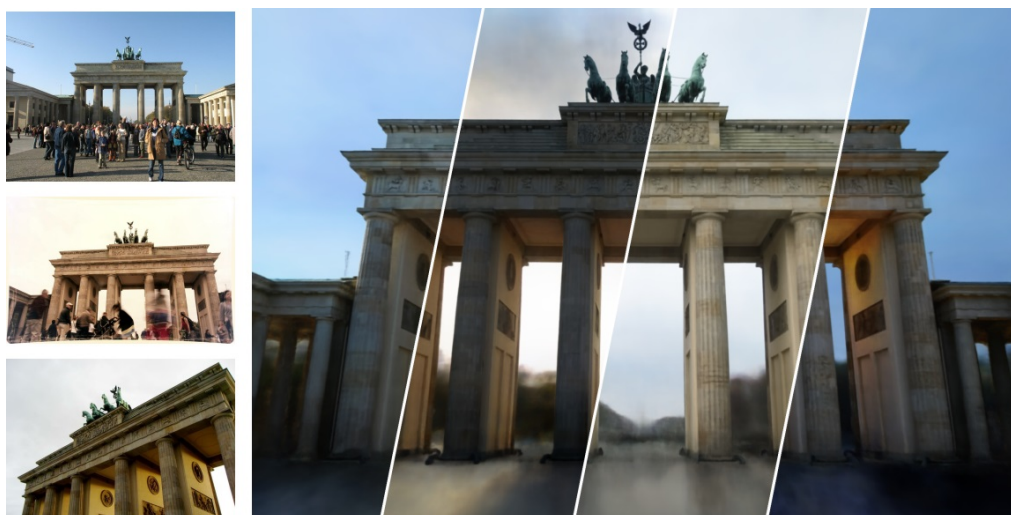
Figura 12 – Renderização com NeRF para recriação de imagens com aspecto de cor variável. Adaptado de (Martin-Brualla et al. 2021).
