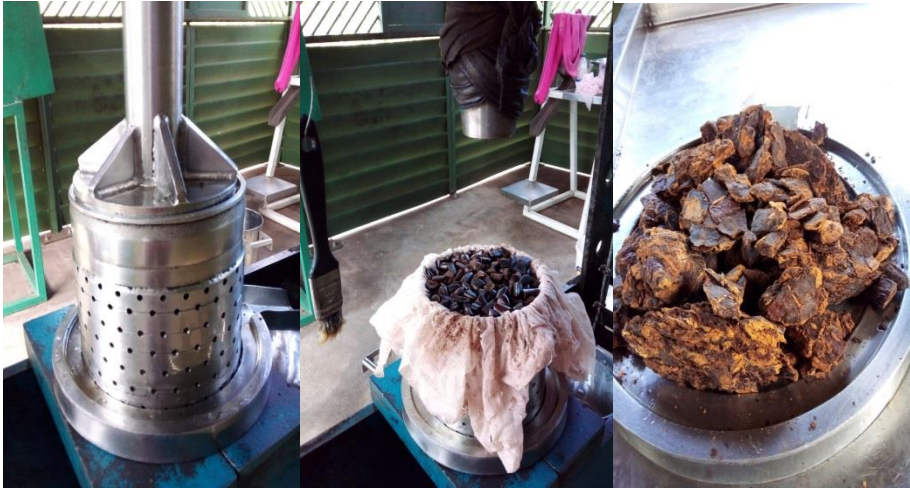
Figura 5. Processo de espremedura à frio da amêndoa do babaçu. Da esquerda para a direita. Maquinário de espremedura a frio, amêndoas no maquinário, e torta, resíduo pós espremedura. Fonte: Autoria própria, 2022.
