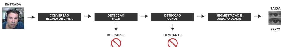
O fluxo apresentado na Figura 12 se inicia com cada uma das imagens capturadas sendo transformadas por meio de Python OpenCV para escalas de cinza para que possam ser interpretadas como uma matriz 2D, formato necessário para a CNN.
