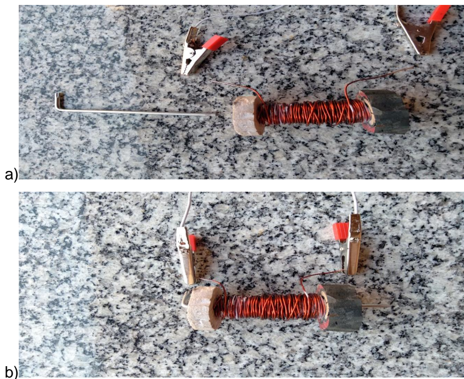
Figura – 18 Solenoide rudimentar sendo mostrado aos alunos (figura já citada anteriormente).
