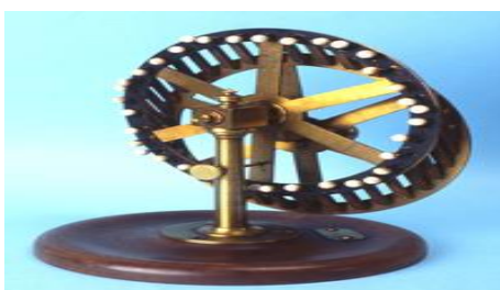
Figura - 14 Modelo construído por Maxwell para explicar os anéis de Saturno. Ao girar, as partículas em translação mostravam uma simulação do que acontecia nos anéis
