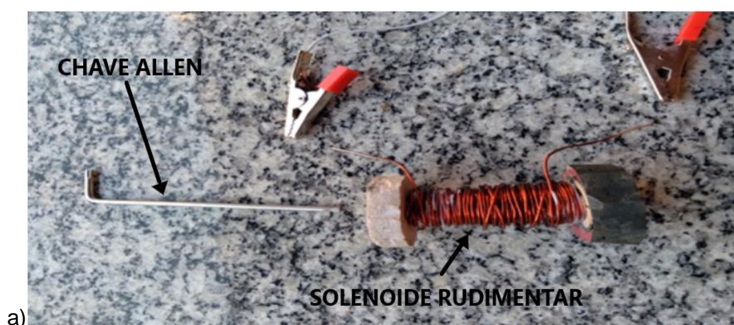
Figura – 18 Solenoide rudimentar que foi usado nos encontros. Em a), não há passagem de corrente. Em b), o solenoide é percorrido por uma corrente e atrai a chave allen.
