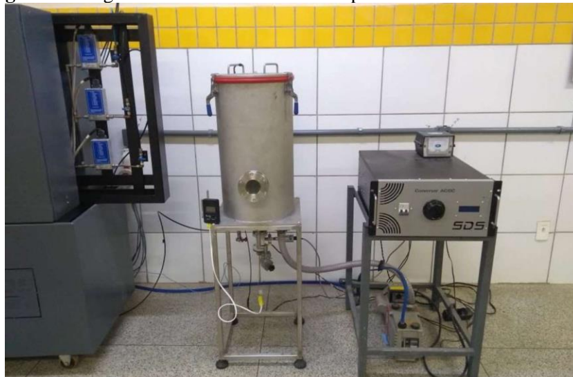
Figura 7: Imagem do reator de tratamento a plasma do LabPlasma – UFPI.
