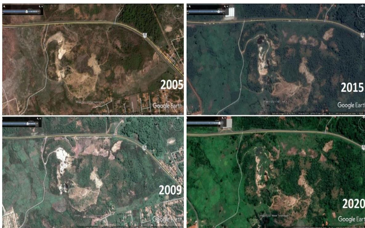
Legenda: Ao ano de 2005 e 2009, com intervenção humana no relevo, com a retirada de material para construção civil; Já em 2015, havendo uma redução da retirada de material e revegetação no local; E para o ano de 2020, uma leve recuperação do local, por revegetação natural rasteira no local. Fonte: Google Earth, adaptado. Rafael José Marques (2021).
