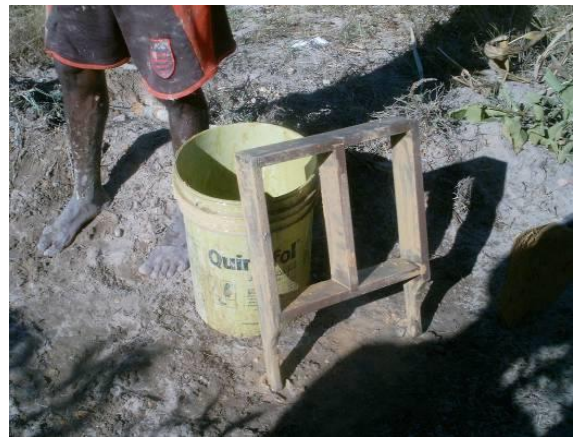
Figura 44. Fôrma em cedro utilizada para a fabricação dos adobes
