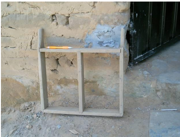
Figura 76. Fôrma de madeira utilizada na confecção dos adobes.
