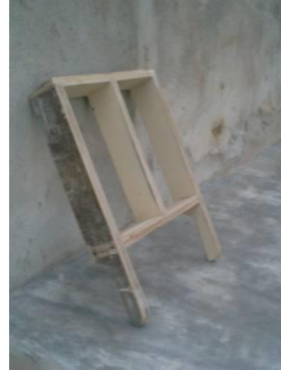
Figura 28. Fôrma usada na confecção dos adobes.
