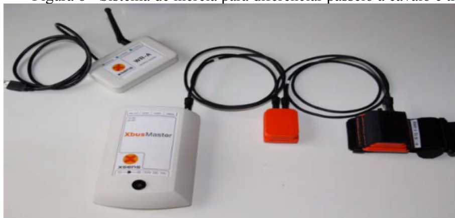
Figura 8 - Sistema de inércia para diferenciar passeio a cavalo e trote
