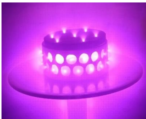
Figura 7- Aspecto visual da formação do plasma na superfície da gaiola.
