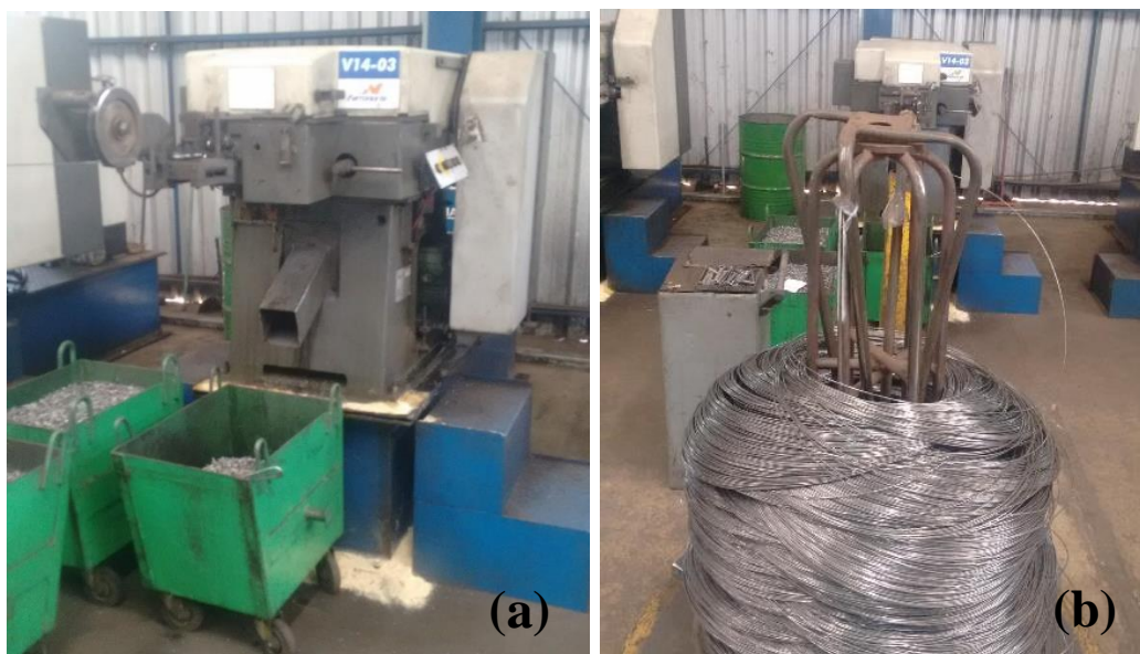
Figura 14 – Máquina utilizada na fabricação de pregos comuns com cabeça: (a) Máquina Vitari modelo V14-R e (b) detalhe do desbobinador e arame utilizado.
