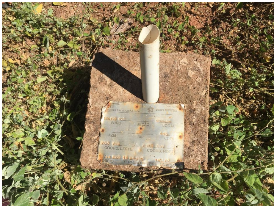
Fotografia 09: Poço perfurado para sondagem mineral (Fonte: arquivo pessoal)
