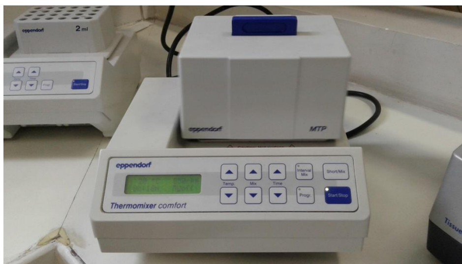
Figura 17. Agitador de placa térmico utilizado durante o procedimento.
