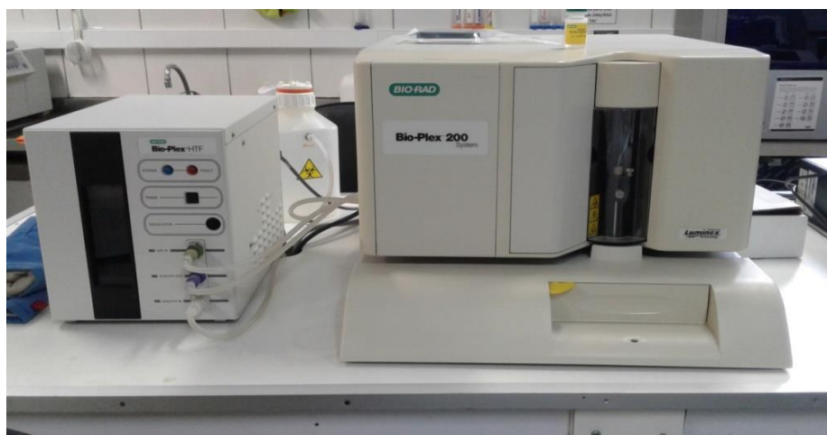
Figura 13. Sistema Bio-Plex 200. Analisador por ensaio de suspensão.
