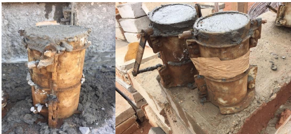
Figura 9. Confecção de corpos de prova com diâmetro de 10 e altura de 20 cm.
