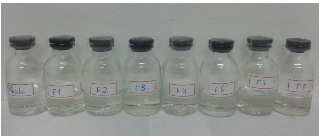
Figura 5: Aspecto visual das microemulsões após o TET (teste de estresse térmico).
