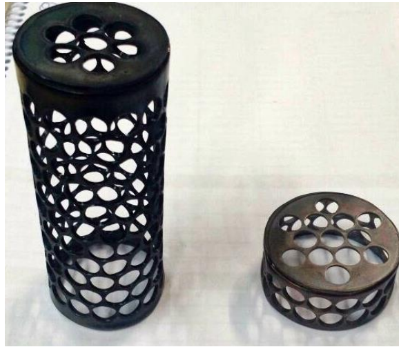
Figura 10 - Gaiolas catódicas confeccionadas para os tratamentos de nitretação em gaiola catódica
