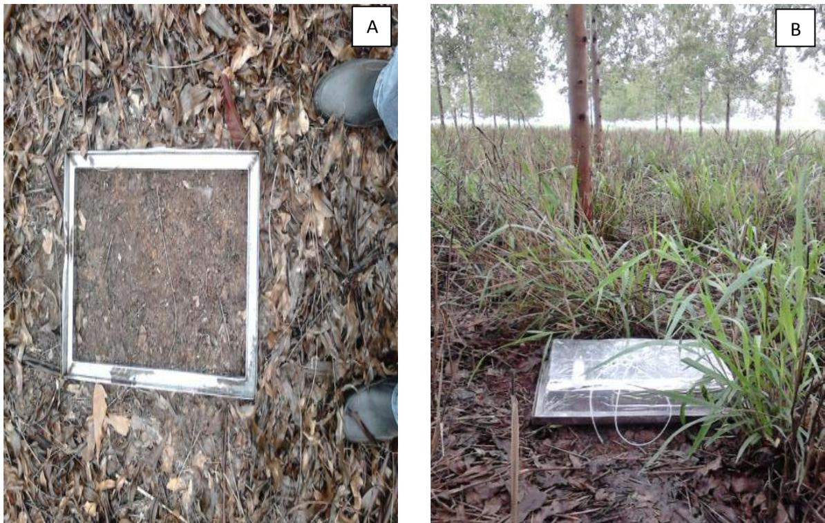
**Figura 3.1.** Modelo da câmara utilizada para coleta das amostras de  $N_2O$ . A. base metálica para encaixa da câmara; B. conjunto base/câmara no sistema de IPF.
