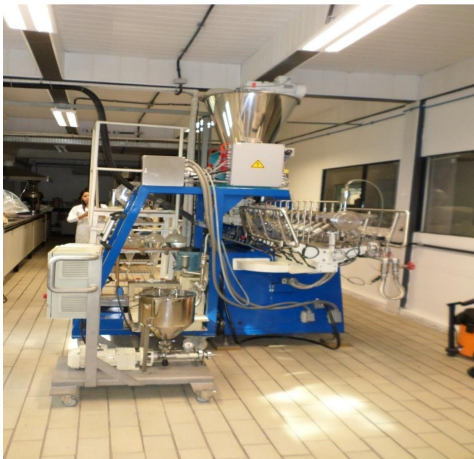
Figura 1. Extrusor termoplástico dupla-rosca (Clextral Evolum HT25, França) utilizado na elaboração dos snacks extrusados.
