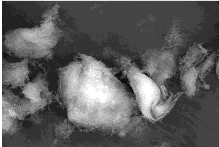
Figura 10 – Fotografia obtida por MEV para amostra de sepiolita.
