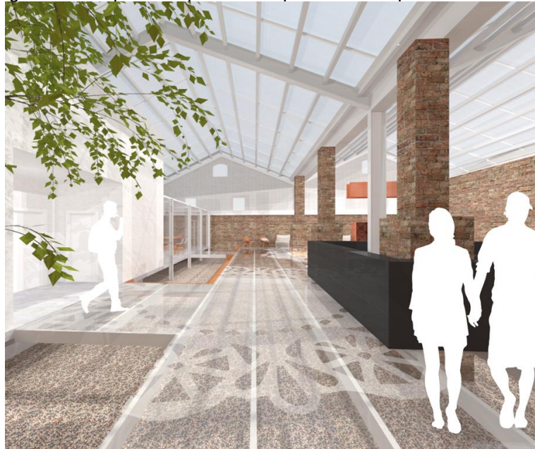
Figura 78: Imagem onde é possível perceber o piso novo suspenso a 50cm do piso original.
