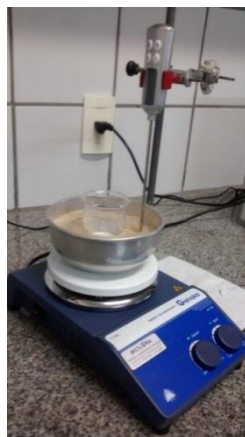
Figura 7: Esquema do banho de areia com temperatura controlada.
