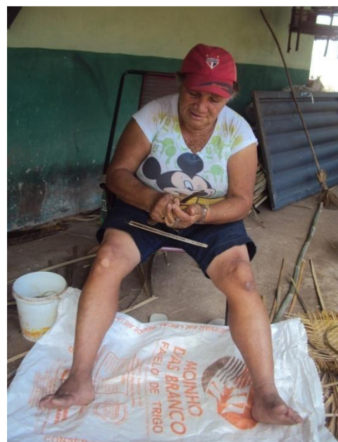
Figura 50- Corte na parte inferior da taboca finalizando o processo de LAVRAR a taboca
