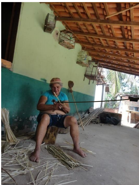
Figura 29- Demonstração do Processo de LAVRAR a tala do quibano ou peneira.
