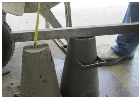
Figura - 04: Slump medido durante a confecção dos corpos de prova
