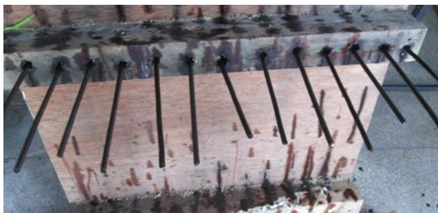
Figura 03: Barras de ferro CA50 pintadas com a resina de LCC
