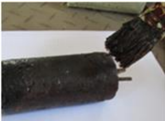
Figura - 06: Teste de impermeabilização em corpos de prova com revestimento de resina de LCC.
