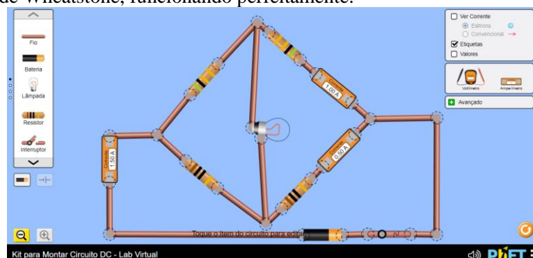
Figura 26. Ponte de Wheatstone, funcionando perfeitamente.
