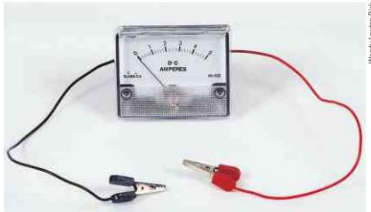
Figura 12. Amperímetro, analógico, cujo valor de fundo de escala é 5 A.
