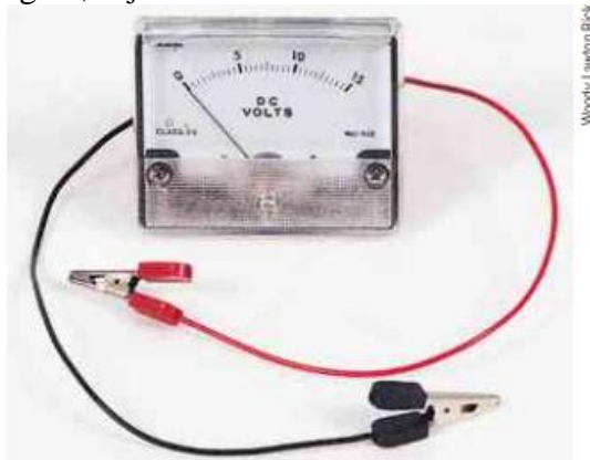
Figura 13. Voltímetro, analógico, cujo valor de fundo de escala é 15 V.
