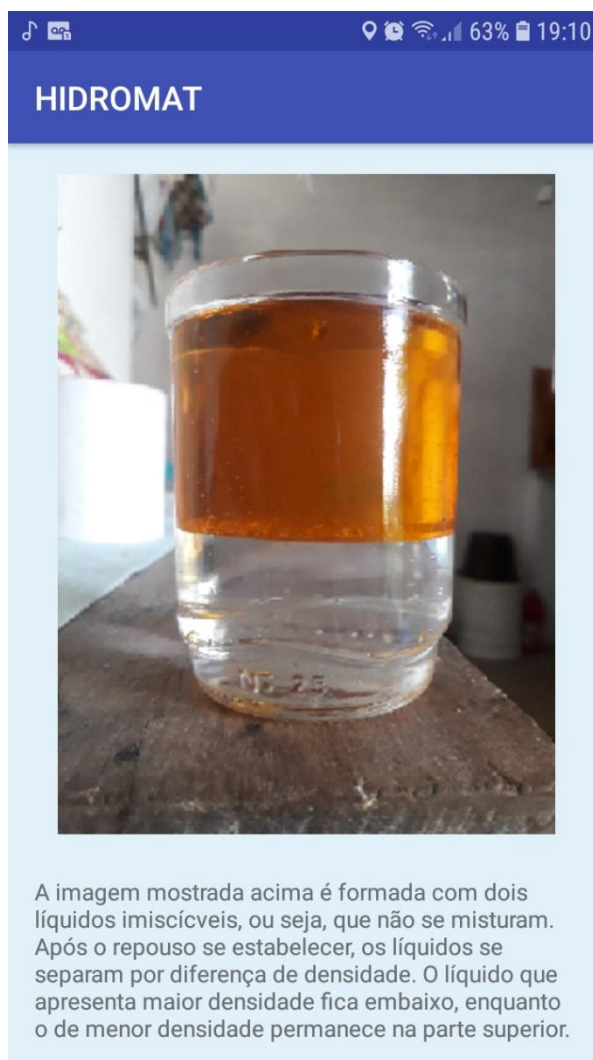
Figura A 9: Explicação para a situação de dois líquidos não se misturarem.
