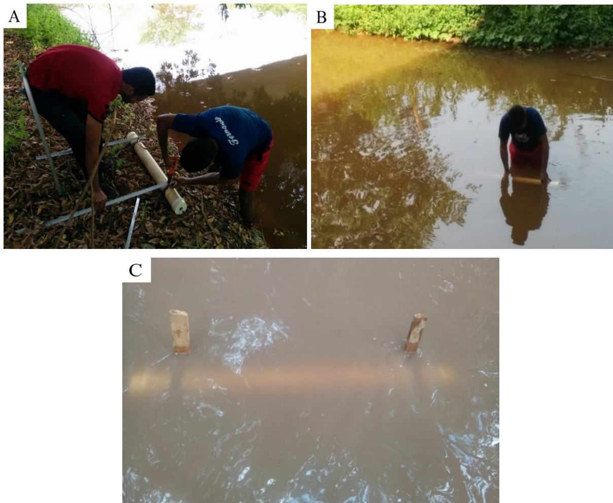
Figura 3- Preparo (a), instalação (b) e coletor instalado no leito do rio (c) do coletor de sedimento em suspensão por integração no tempo no leito do rio Gurguéia no sul do Piauí, Brasil.
