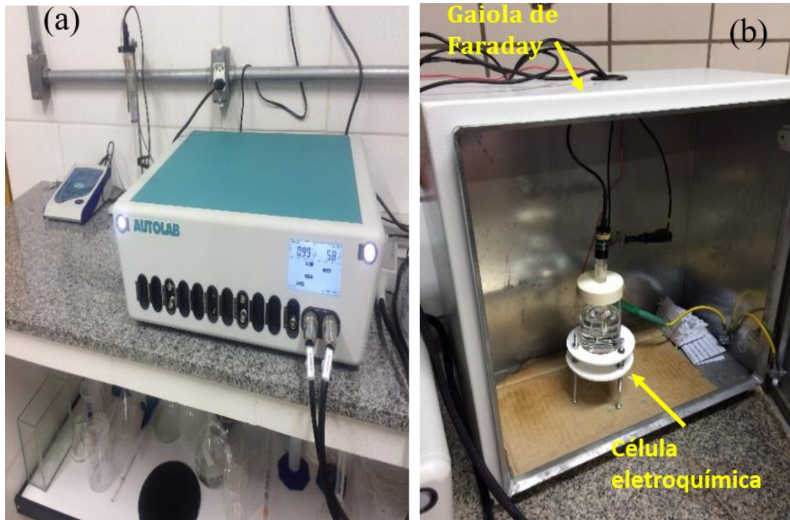
Figura 22 – (a) Potenciostato Autolab PGSTAT302N e (b) célula eletroquímica de três eletrodos.
