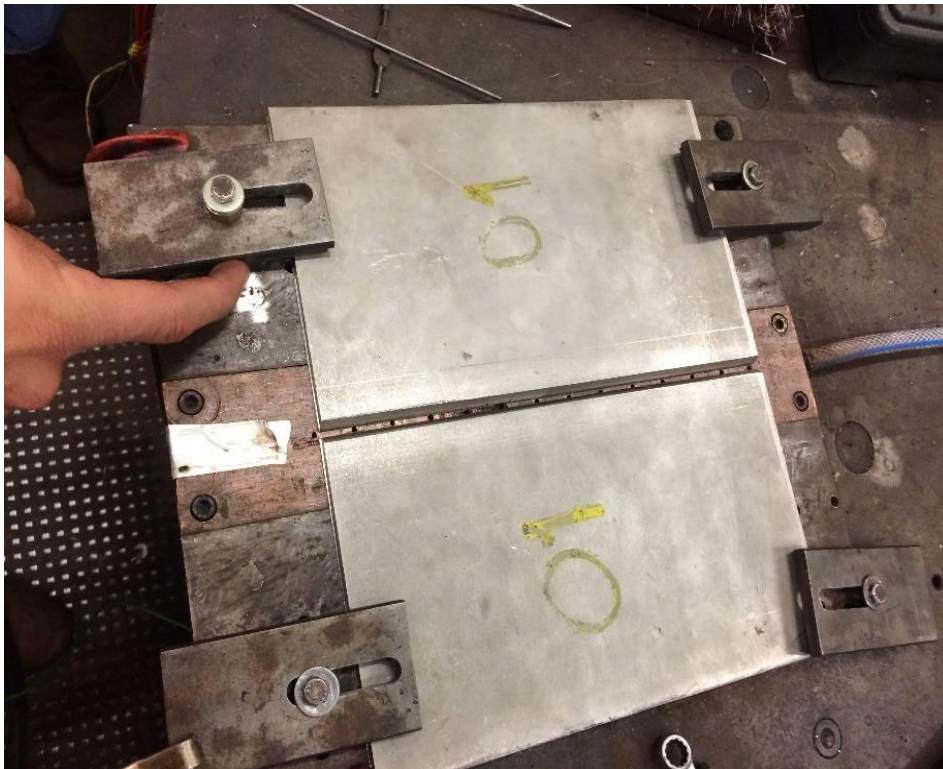
Figura 15 – Junta a ser soldada sobre dispositivo de purga da raiz.
