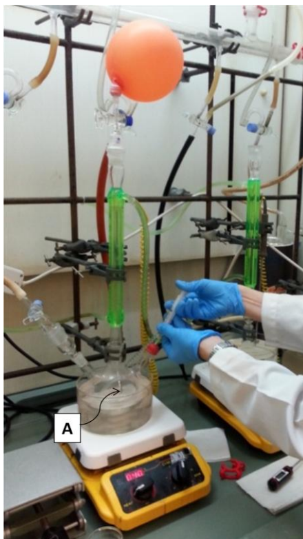
Figura 7: Adição do ácido oleico e oleilamina à solução de hexadecan-1-ol 0,3 \text{ mol.L}^{-1} em 35 mL de NMP. (A) solução incolor.
