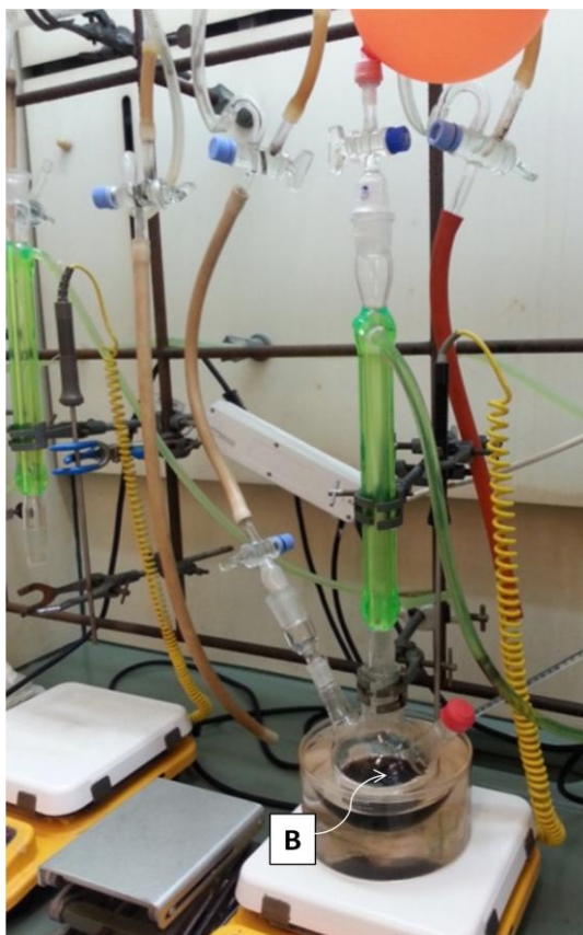
Figura 8: Reação com a solução [\text{Fe}(\text{acac})_3] 0,15 \text{ mol.L}^{-1} a 200 \text{ }^\circ\text{C} . (B) solução acastanhada.
