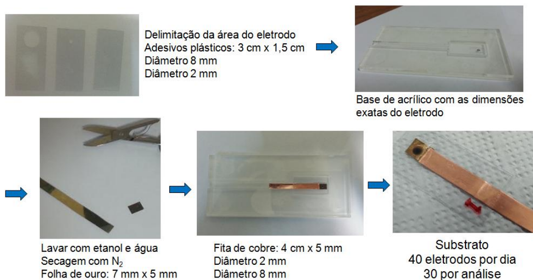
Figura 12: Procedimento manual de montagem do eletrodo base.
