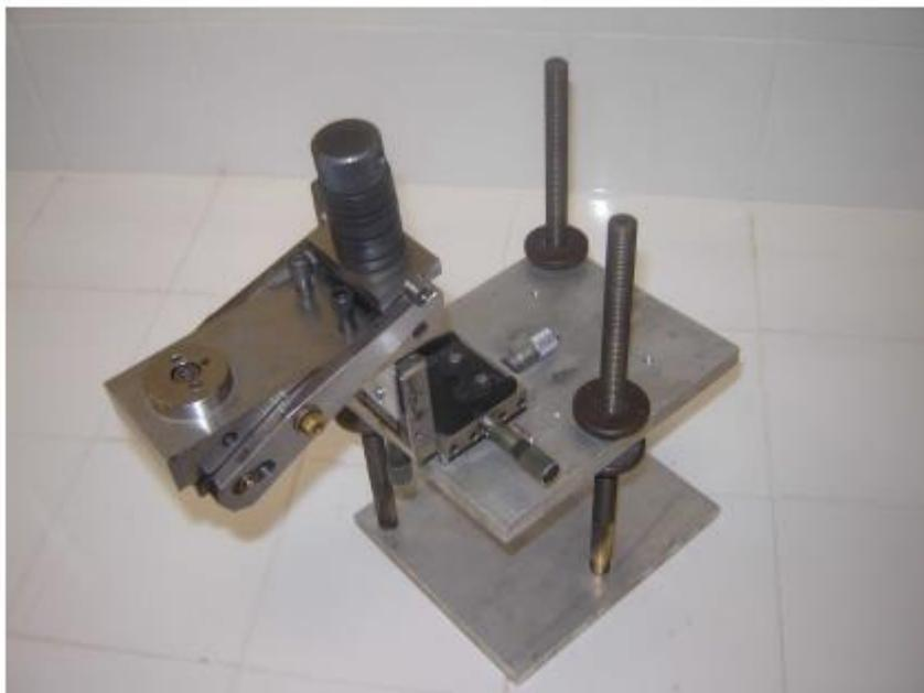
Figura 11: (a) Célula de pressão hidrostática utilizada nos experimentos de espectroscopia Raman; (b) Vista ampliada da gaxeta da célula de pressão.
